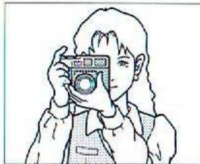
Dans la plupart des cas, une prise de vue floue résulte d'un bougé lors du déclenchement. Tenir fermement l'appareil au niveau des épaules et près du corps pour une meilleure stabilité, puis, déclencher. Ne pas effectuer des prises de vues supérieurs au 1/30ème à main levée. Il est préférable d'utiliser dans ce cas un trépied et un câble déclencheur.
