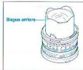
4) Lorsque l'on monte le 43mm, 50mm ou le 65mm, s'assurer de ne pas toucher la bague arrière de l'objectif avec le couplage du télémètre.
